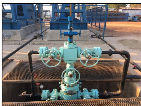
1) อุปกรณ์ชุดวาล์วปากหลุม (Well Head Unit)
