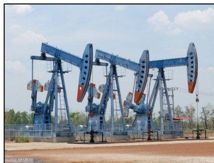
2) เครื่องสูบบนโยก (Beam Pump)
