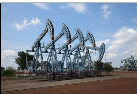
2) เครื่องสูบน้ำแบบโยก (Beam Pump)
