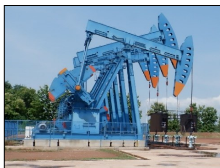
2) เครื่องสูบน้ำแบบโยก (Beam Pump)
