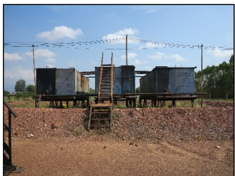
5) ถังเก็บน้ำมันดิบแบบชั่วคราว (Crude Oil Tank)
