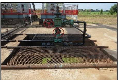
1) อุปกรณ์ชุดหัวปลวกหลุม (Well Head Unit)
