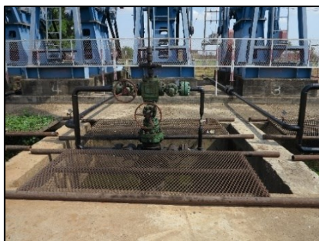
1) อุปกรณ์ชุดหัวปลวกหลุม (Well Head Unit)
